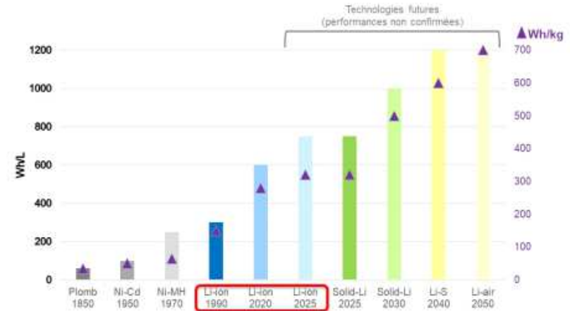
Perspectives d'évolution des densités d'énergie massique et volumique des cellules, source Renault
